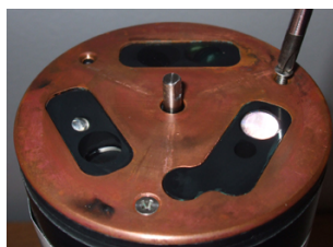
Figure 6 Plateau en cuivre fixé à la plaque optique
