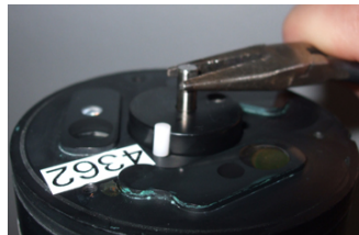
Abbildung 5 Wischermotor vom Sensor entfernt
