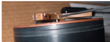
Abbildung 2 Gelöste Stellschraube des Wischers
