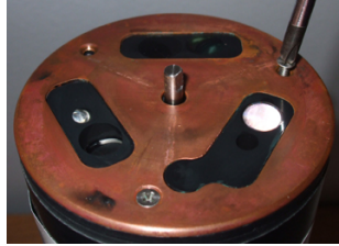
Abbildung 6 An optischer Fläche befestigte kupferne Frontplatte.
