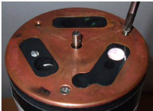
Figura 6 Placa frontal de cobre montada sobre la cara óptica
