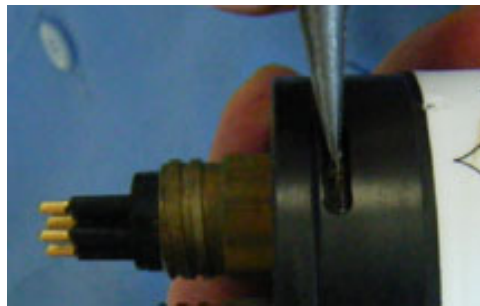
Figura 7 Tire del monofilamento de la brida final.
