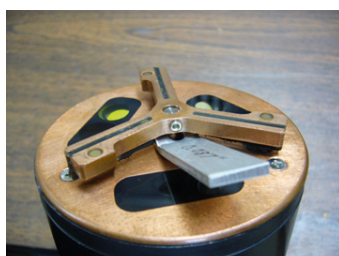
Figura 3 Calibrador de altura del contacto deslizante insertado
