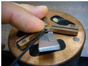
Figura 4 Contacto deslizante sujeto con el tornillo de fijación
