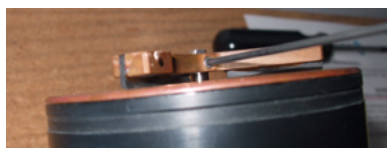
Figura 2 Tornillo de fijación del contacto deslizante aflojado
