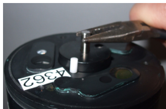
Figura 5 Motor del contacto deslizante extraído del sensor
